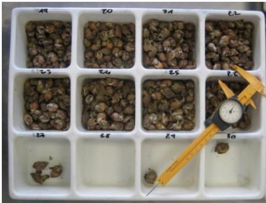
Figura 3 – Calibro e vaschette utilizzate per la misurazione e la suddivisione in classi di taglia da un millimetro.
